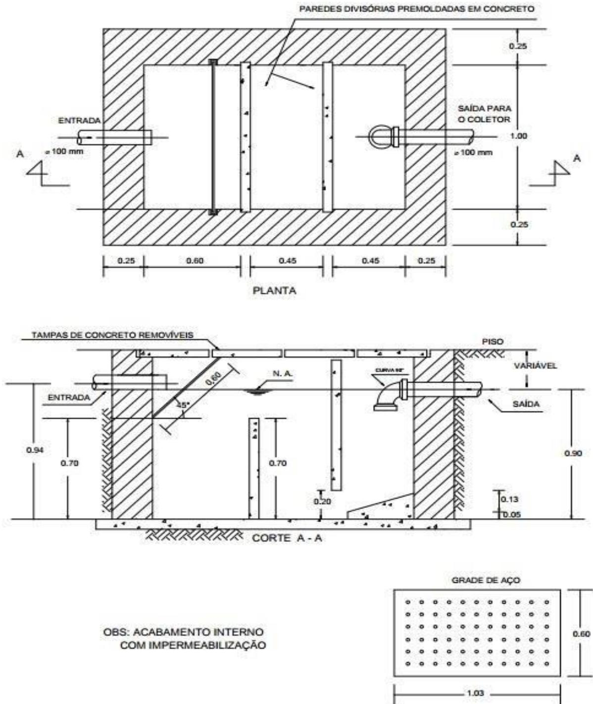
**Figura 07: Caixa Retentora de Resíduos de Fabricação de Pisos (Ardósia, Granito, Mármore, etc.)**
