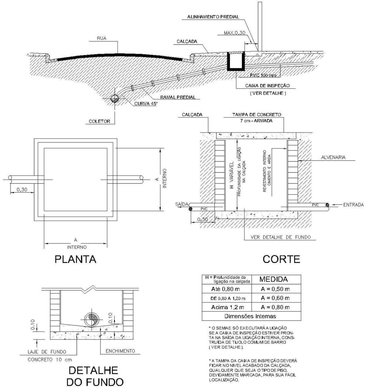
**Figura 02: Detalhe da Ligação de Esgoto**
